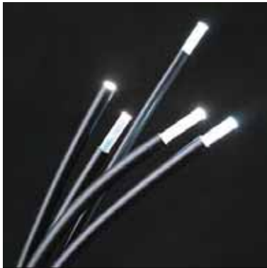
شكل ( ٣-٢٦): الألياف الضوئية وهي مصنوعة من شعيرات زجاجية أو بلاستيكية تستطيع نقل الضوء (المصدر: Google Search Engine)
